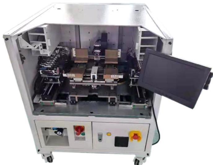
此设备可以测试笔记本左右两侧各类IO，外观可以根据实际情况做调整，通用型设备，可兼容测试产品尺寸11-17寸。
